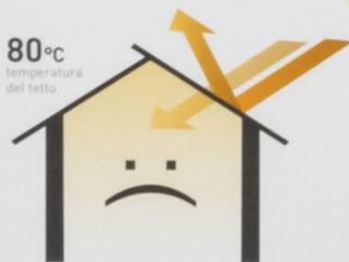
senza Stereofix Plus il calore irradiato dal sole è in parte riflesso ed in parte assorbito, inoltre l'irraggiamento nell'infrarosso va a riscaldare notevolmente la copertura ed il locale sottostante.
